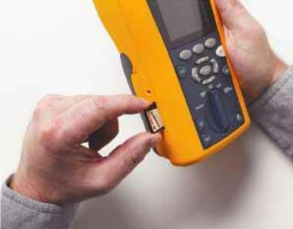
图一，高容量的可抽取式存储介质，像这种多媒体卡一样，使集成商可以存储大量详尽的测试数据用于提供有依据的质量保证。
