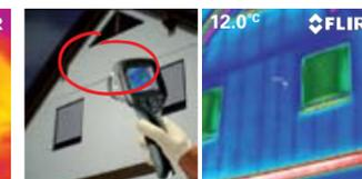
热检查发现墙面隔热不良
